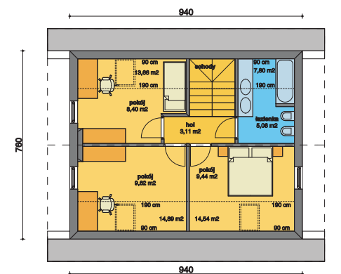
Rzut piętra – 35,60 m 2 (powierzchnia podłogi 54,00 m 2 )
