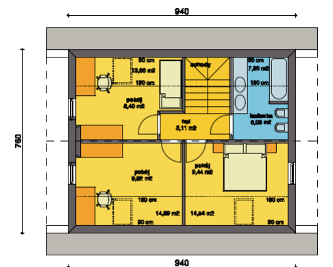
Rzut piętra – 35,60 m 2 (powierzchnia podłogi 54,00 m 2 )
